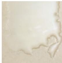
Die Farbbeschichtung der Textura Fassadentafel ermöglicht eine interessante Fassadengestaltung mit kräftig deckenden Farben. Kleinste Fillite (Kügelchen) in der Oberfläche bewirken
