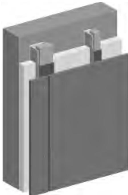
Für größere Dämmstoffdicken kann die vertikale Traglattung durch metallische Winkel- bzw. U-Abstandhalter mit thermischem Trennelement aufgeständert werden. Die Korrosionsbeständigkeit der Abstandhalter gegenüber den verwendeten Holzschutzmitteln muss gegeben sein.
