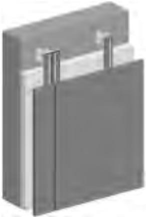
Die allgemeine bauaufsichtliche Zulassung Z-10.8-408 zur Befestigung von Eternit Fassadentafeln aus Faserzement auf einer Unterkonstruktion aus Aluminium mit dem Klebesystem „SikaTack-Panel“ ermöglicht folgende Gestaltungsfreiheiten:
