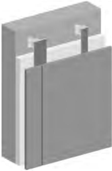
Für den Neubau und die Sanierung von Fassaden werden zur Aufnahme der Bekleidung verschiedene Unterkonstruktionen aus Aluminium angeboten. Ihre Standsicherheit ist in der Regel an Hand der vorliegenden technischen Baubestimmungen rechnerisch nachzuweisen. Im Falle nicht rechenbarer Systeme, z. B. Klemmbefestigung, ist eine allgemeine bauaufsichtliche Zulassung der Konstruktion erforderlich.
