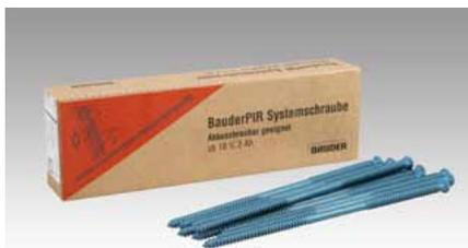
Spezialschraube für BauderPIR Wärmedämmelemente auf den Sparren. Konterlatten-Elementebefestigung in der gesamten Dachfläche. Keine statisch dimensionierte Traufbohle/Knagge nötig. Akkuschraubertauglich.
