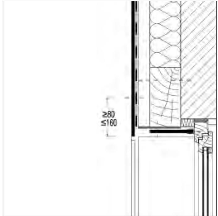
Regelausführung mit Streifen aus Faserzement Fassadentafeln und Lüftungsblechen.
