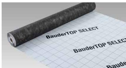
Dampfbremse mit einstellbarem  $sd$ -Wert für die Dachsanierung von außen.  $sd$ -Wert  $\leq 0,1 \text{ m}$  (Folie abgezogen);  $sd$ -Wert  $\geq 4,6 \text{ m}$  (Folie belassen)
