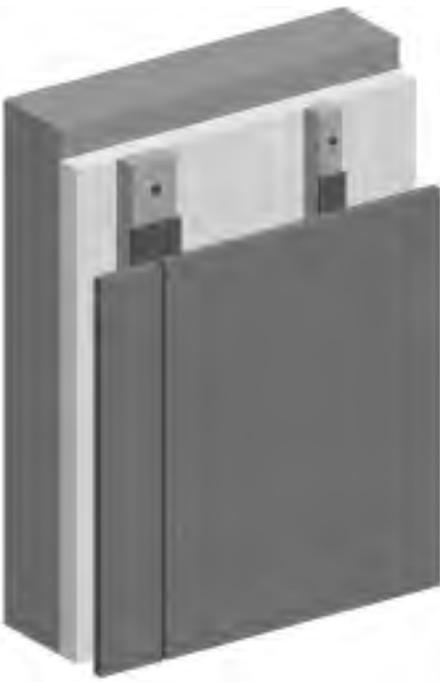
Vertikale Traglattung verlegt auf Dämmung ohne Abstandhalter. Aufnahme des Eigengewichtes der Konstruktion durch geeignete Rahmendübel nach statischen Erfordernissen. Befestigung des Dämmstoffs mit Dämmstoffhaltern nach Vorgabe des Dämmstoffherstellers.
