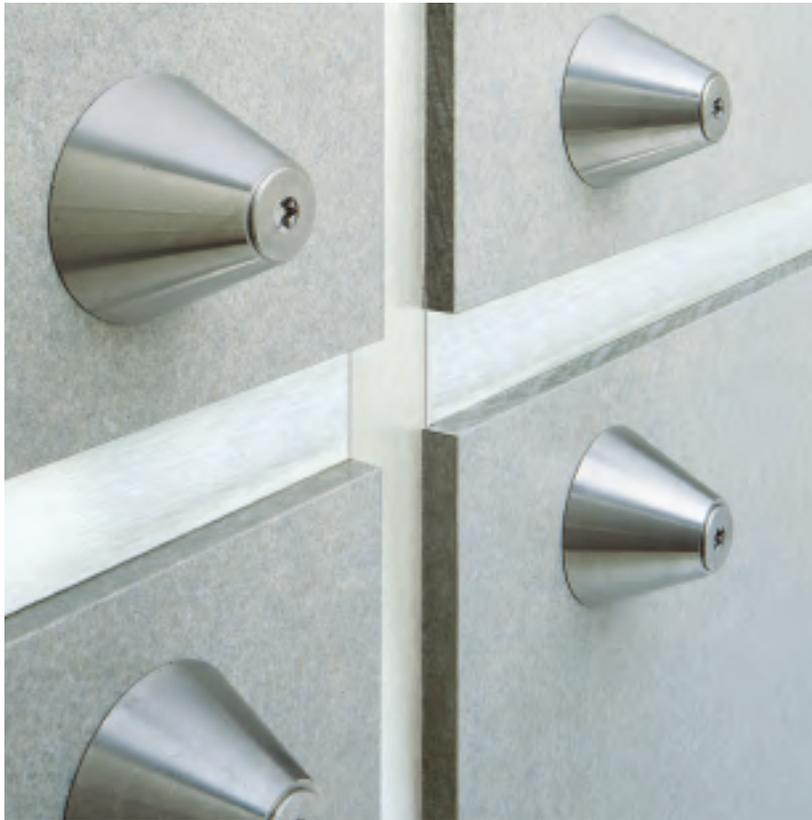
Eternit-Naxo ist die Kombination zweier hochwertiger Werkstoffe: Faserzement und Edelstahl. Zur Befestigung auf Holz- oder Aluminium-Unterkonstruktionen dienen jeweils ein massives Naxo-Element und eine Edelstahlschraube bzw. ein Edelstahl-/ Aluminiumniet. Die Faserzementtafeln werden von Fugenbändern aus geschliffenem Edelstahl umrandet. Das Spektrum der geometrischen Formen der Naxo-Elemente ist offen. Über die hier gezeigten Formen hinaus sind weitere Varianten realisierbar.
