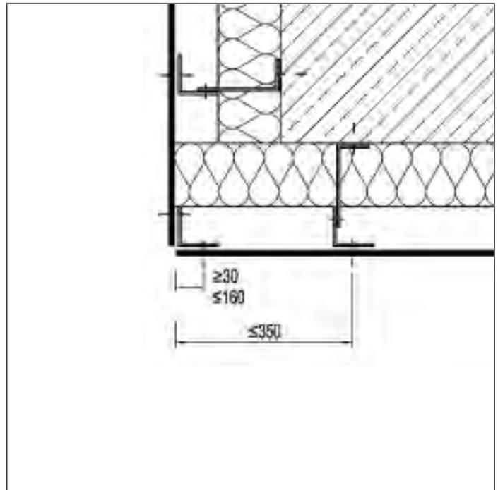
Eckausbildung bei Verwendung einer Aluminium-Unterkonstruktion. Die Ecke wird mit einem Winkelprofil aus Aluminium hinterlegt. Der Dämmstoff bildet eine vertikale Windsperre.
