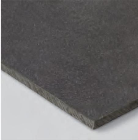
**Werkstoff:** hochwertige durchgefärbte Fassadentafel aus Faserzement (DIN EN 12467)
