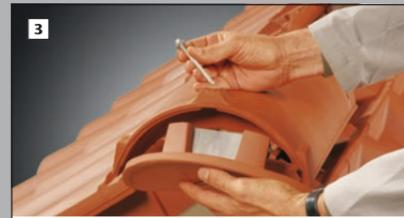
Die Funktionsanfang- und -endscheibe wird mit dem Firstziegel verschraubt. Dabei bohrt sich die selbstschneidende Spezialschraube ohne Vorbohren in die Aluminiumplatte der Funktionsanfang- und -endscheibe (die Spezialschraube ist im Lieferumfang der Funktionsanfang- und -endscheibe enthalten).
