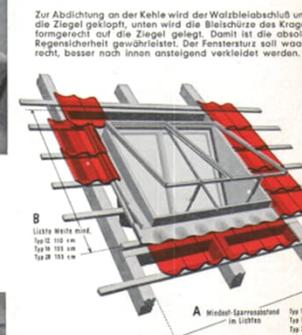
Zur Abdichtung an der Kehle wird der Walzbleiabschluss unter die Ziegel geklopft, unten wird die Bleischürze des Kragens formgerecht auf die Ziegel gelegt. Damit ist die absolute Regelmäßigkeit gewährleistet. Der Fenstersturz soll waagrecht, besser noch innen ansteigend verkleidet werden.
