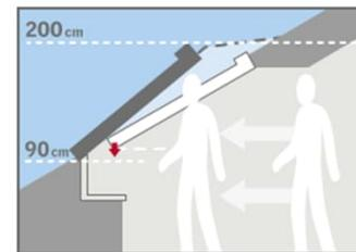
Bei Einbau der Fenster mit VELUX Aufkeilrahmen wird die Fensterlänge nicht nach der vorhandenen Dachneigung gewählt, sondern nach der um 10° steileren Neigung der Fenster durch den Aufkeilrahmen.
